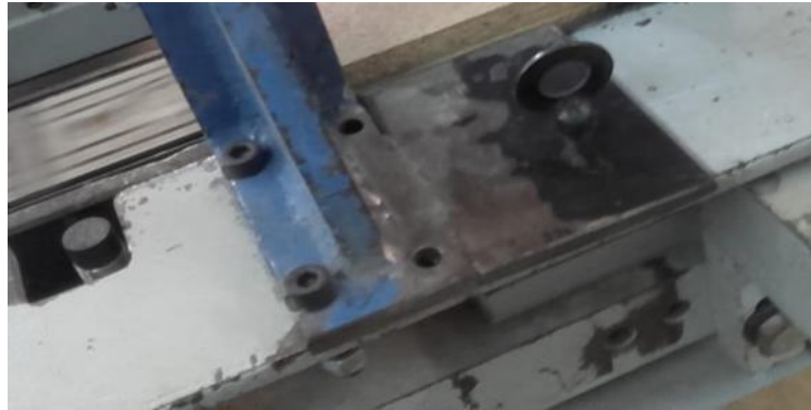
FIGURA 18 – ALTERACAO NA FIXACAO DO MAGAZINE DE PECA
