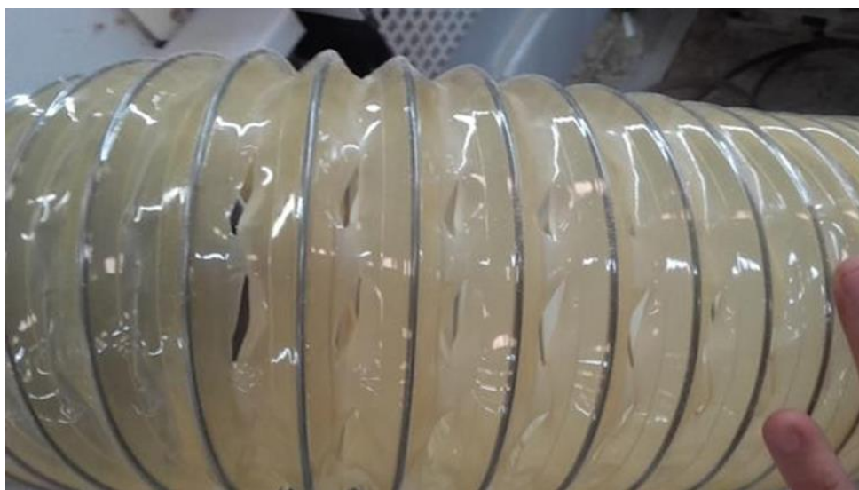
FIGURA 15 – MANGUEIRA DE EXAUSTAO DA TUPIA
