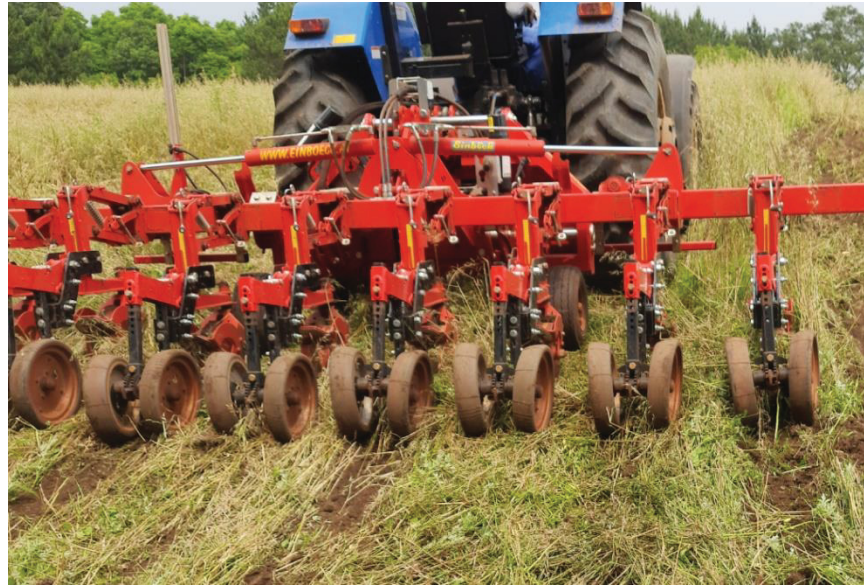
FIGURA 5 – Capinadora automatizada Row-Guard Chopstar Hybrid, importada da Áustria pela empresa GEBANA e adaptada para o sistema plantio direto orgânico.
