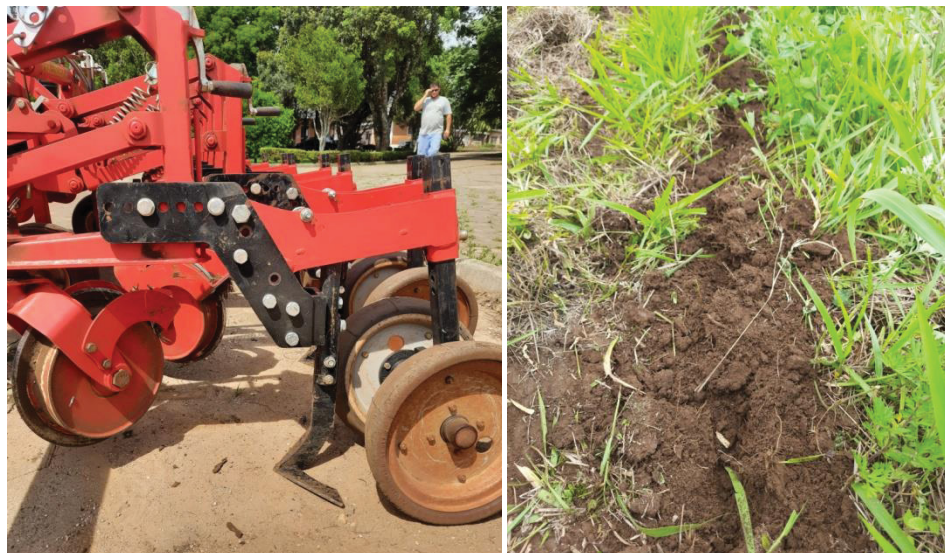
FIGURA 6 – Componentes da capinadora: haste de aço em formato de asa de andorinha; disco de corte / limitador de profundidade; roda compactadora (esquerda). Corte do solo provido da haste (direita).
