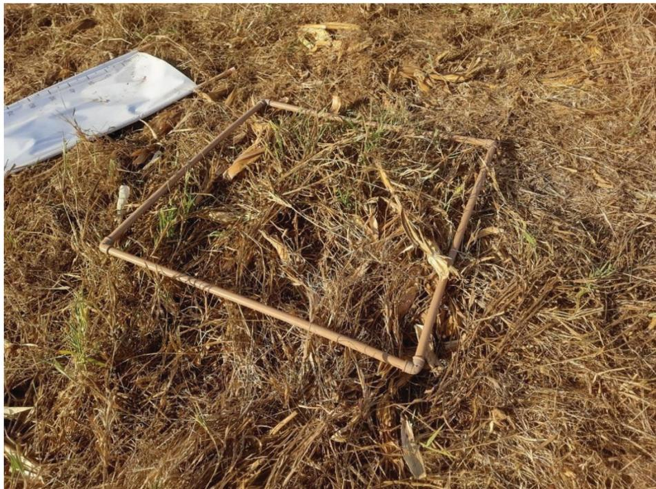
**Figura 2.** Representação do gabarito utilizado para o trabalho de levantamento. Com arestas de 1 metro. Fonte: Elton Gaudêncio.
