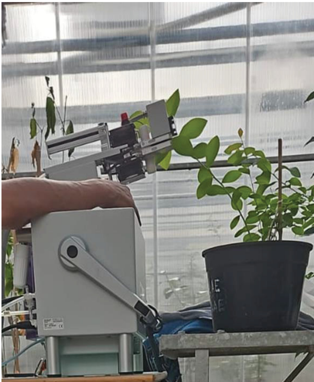
FIGURA 6 – EQUIPAMENTO INFRA-RED GAS ANALYZER (IRGA) REALIZANDO LEITURA DA FOLHA DE MIRTILEIRO 'DELITE'
