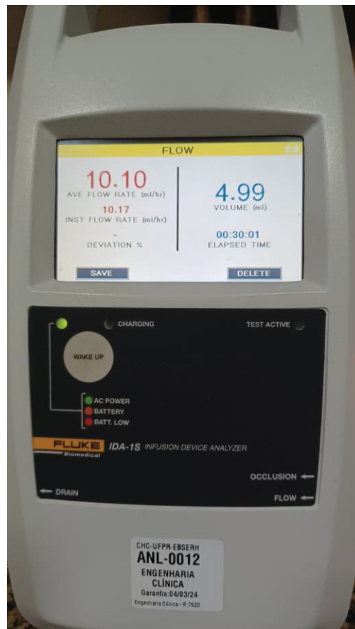
FIGURA 7 – ANALISADOR DE BOMBA DE INFUSÃO FLUKE
