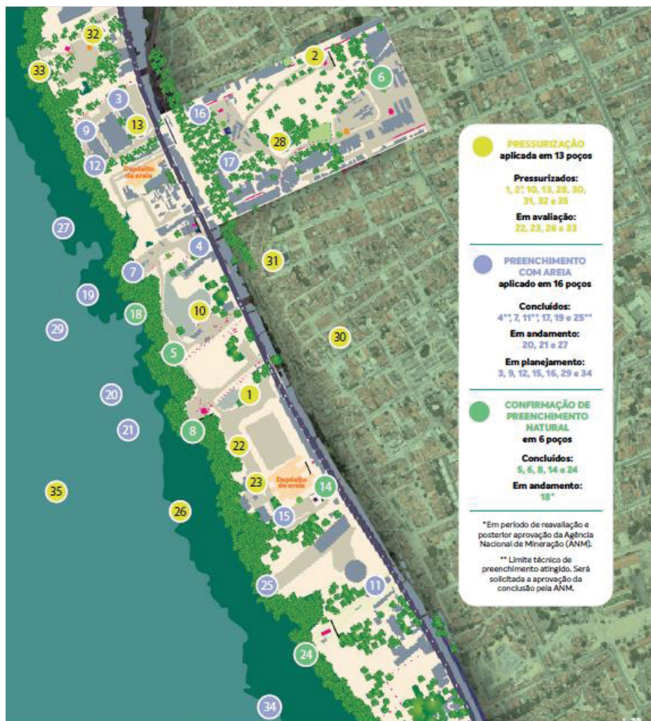
FIGURA 4 - INFORMAÇÕES SOBRE FECHAMENTO DOS POÇOS DE SAL (JANEIRO DE 2025)
