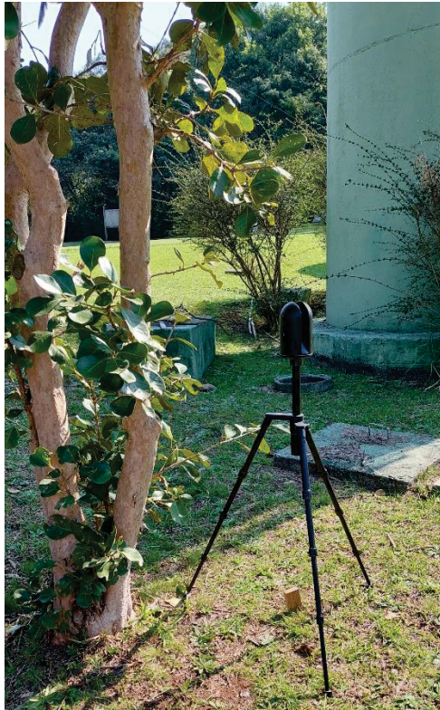
Figura 42 - A estação deslocada pela presença de uma árvore
