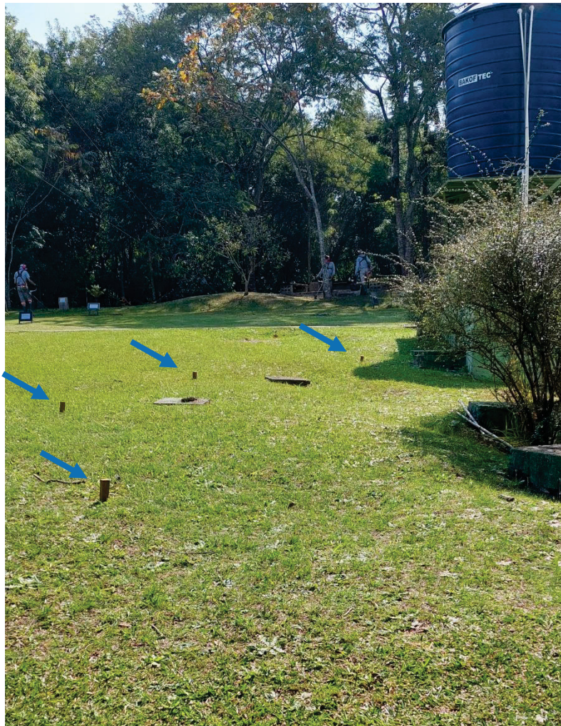
Figura 38 - Estações Locadas em formação circular entorno do objeto (indicado por setas)
