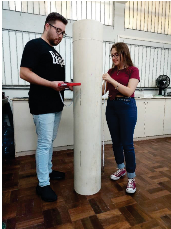
Figura 34 - Mensuração de um curso com o uso de Trena Métrica de Fita de PVC pelo Método de Arqueação
