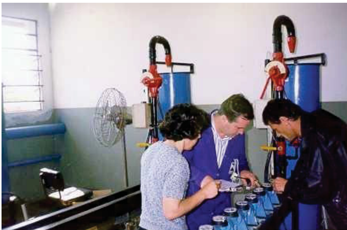
Figura 04 - Verificação de Hidrômetros em Bancada
