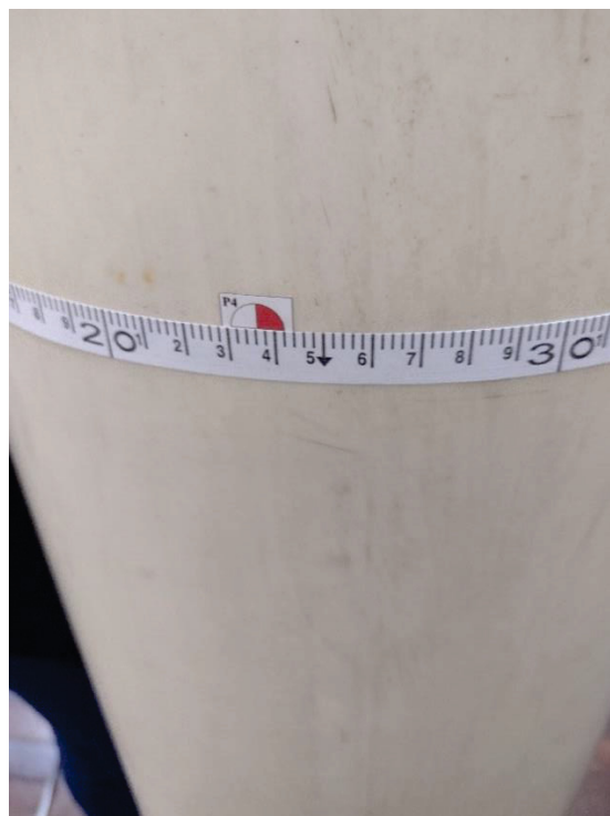
Figura 31 - Trena Métrica de PVC devidamente horizontalizada materializando um curso passando sobre uma seção
