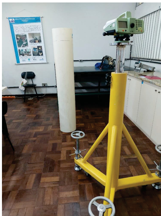
Figura 26 - Nível Geodésico Leica DNA03 instalado no tripé industrial visando a Seção de Referência implantada na tubulação DN300
