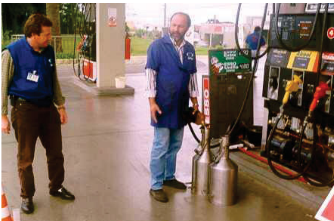
Figura 05 - Verificação de Bombas medidoras para combustíveis líquidos
