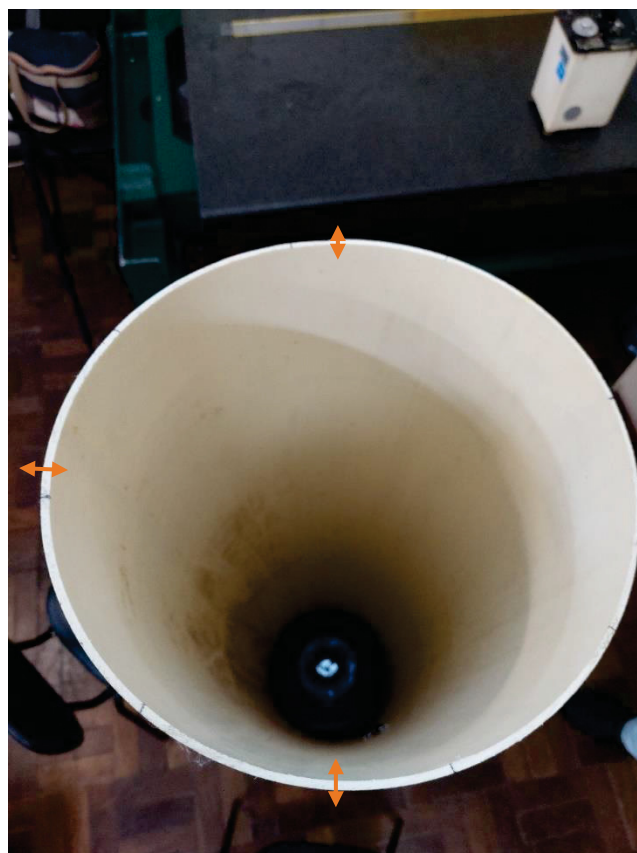
Figura 29 - Discrepância e irregularidades nas espessuras na Tubulação indicadas pelas setas
