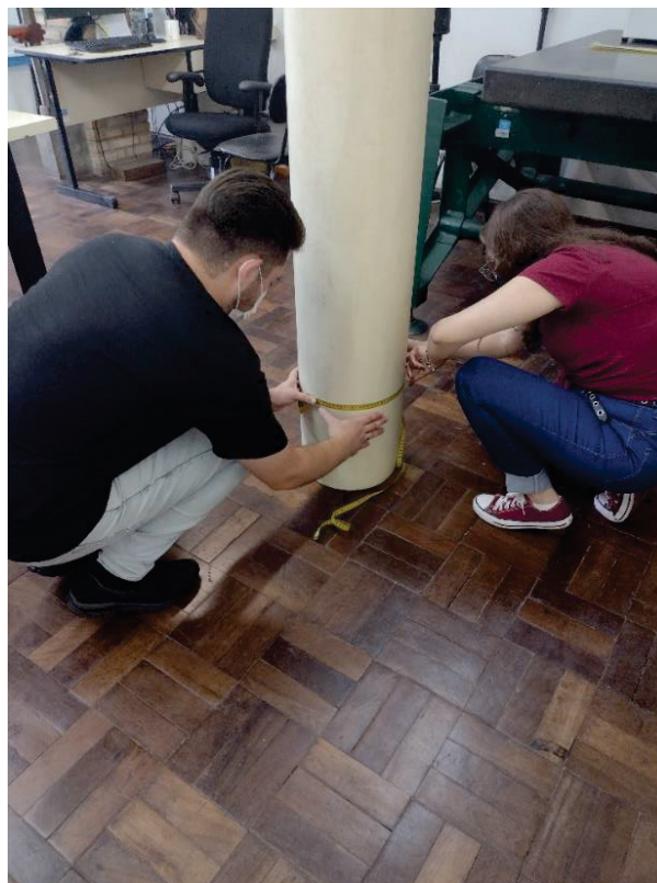
Figura 33 - Mensuração de um curso com o uso de Fita Métrica de PVC pelo Método de Arqueação
