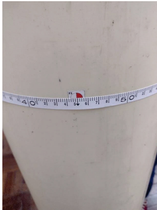
Figura 32 - Trena Métrica de PVC devidamente horizontalizada materializando um curso passando sobre uma seção
