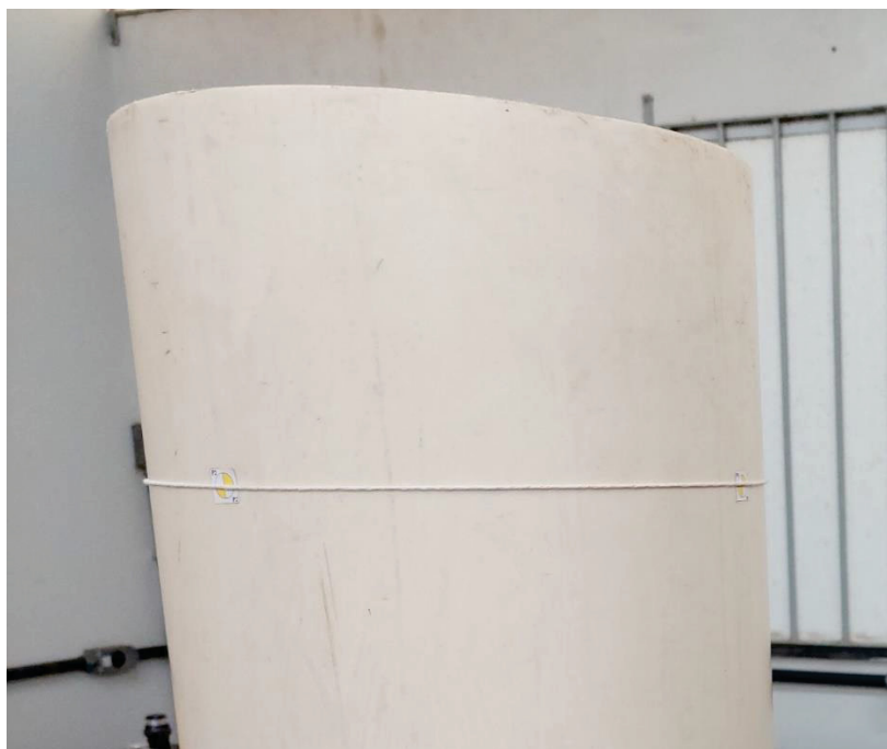
Figura 24 - Seção de Referência materializada com o barbante e os alvos
