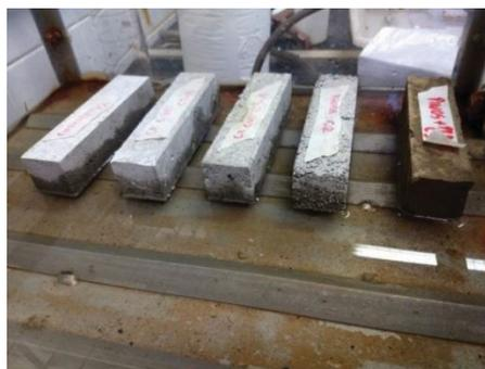
FIGURA 04 – Corpos de prova posicionados em recipiente com 5 mm de água
