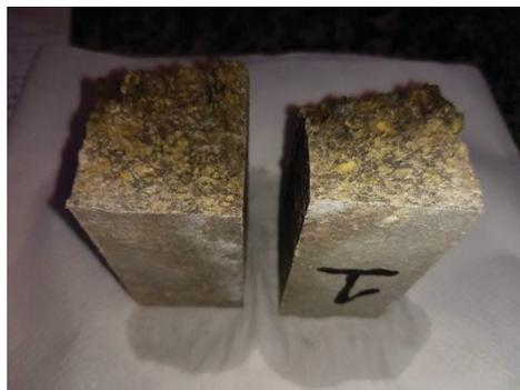
FIGURA 05 – Corpo de prova com compósito de caixa de ovo após teste de flexão
