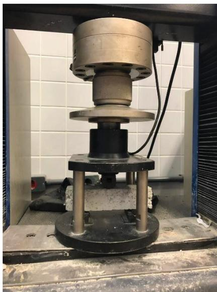
FIGURA 2- Prensa realizando ensaio de tração à flexão
