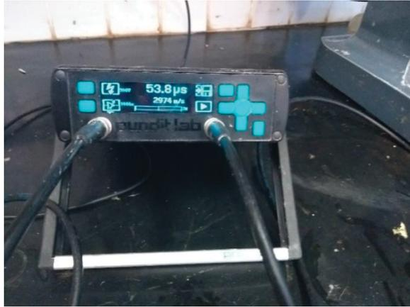
FIGURA 1: Equipamento usado no método de ultrassom
