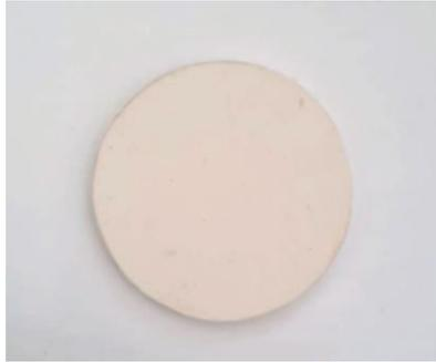
Figura 10. Membrana preparada a partir de argilas locais tratadas termicamente.
