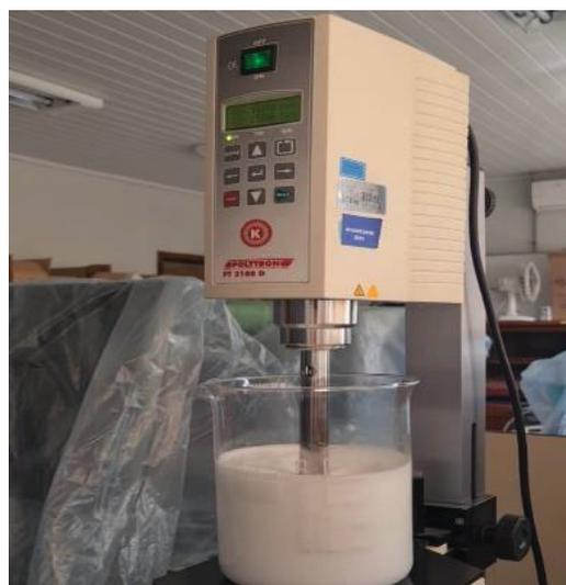
Figura 9. Homogeneizador Polytron PT3100D.
