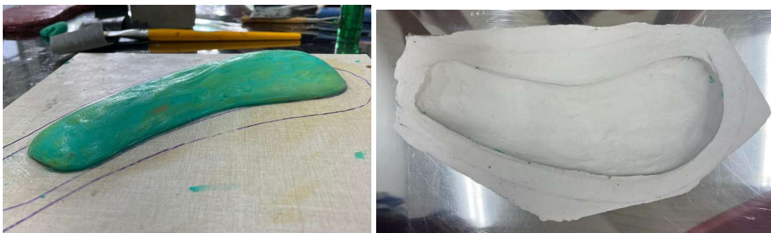
Figura 7. Molde positivo de plastilina e molde negativo de gesso, respectivamente, para confecção do baço.
