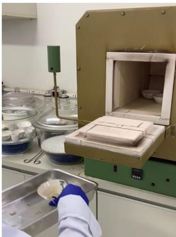
Figura 3 – Análise para caracterização do efluente bruto, para definição de sólidos (totais e suspensos)
