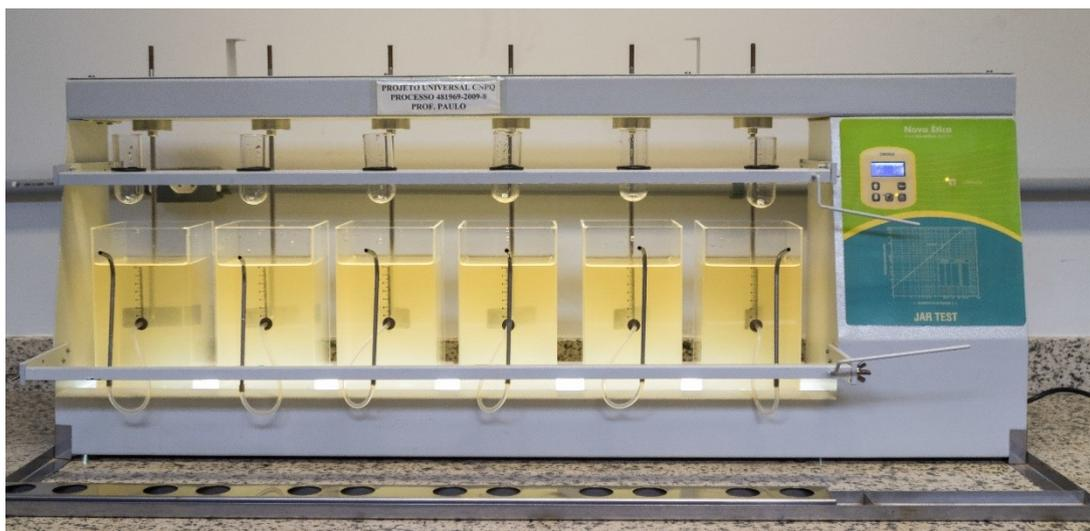
Figura 5 – Modelo do equipamento Jar Test utilizado nos experimentos
