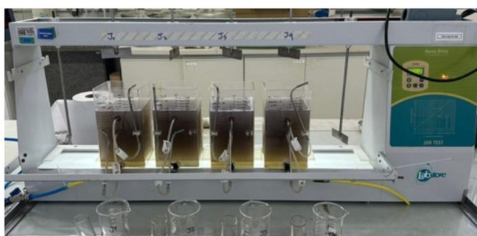
Figura 6 - Equipamento *flotatest* utilizado no experimento, já com o efluente bruto
