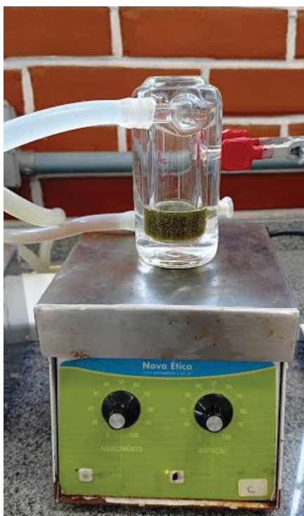
FIGURA 7. PROCESSO DE EXTRAÇÃO EM CÉLULA ENCAMISADA DAS FOLHAS DA PITANGA
