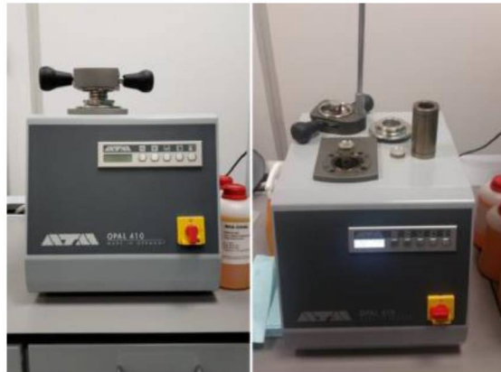
FIGURA 16 – EQUIPAMENTO DE EMBUTIMENTO A QUENTE OPAL 410® - QATM
