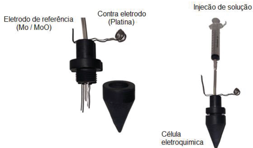
FIGURA 17 CÉLULA ELETROQUÍMICA DESENVOLVIDA PARA O APARATO EXPERIMENTAL
