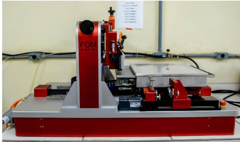
**Figura 60:** Foto da impressora slot die do laboratório DiNE.
