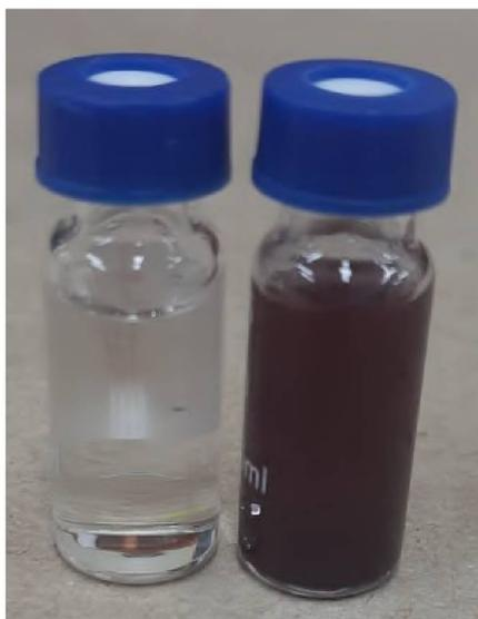
**Figura 72:** Foto das soluções logo após o processo de produção (à direita) e após passagem pelo filtro individual (à esquerda).
