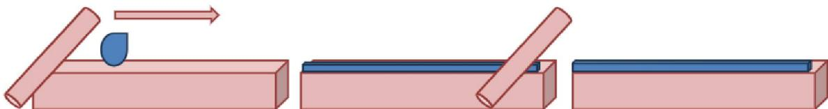
**Figura 61:** Representação do método de deposição por Blade Coating, onde em azul temos o material a ser depositado e o cilindro representando a lâmina.
