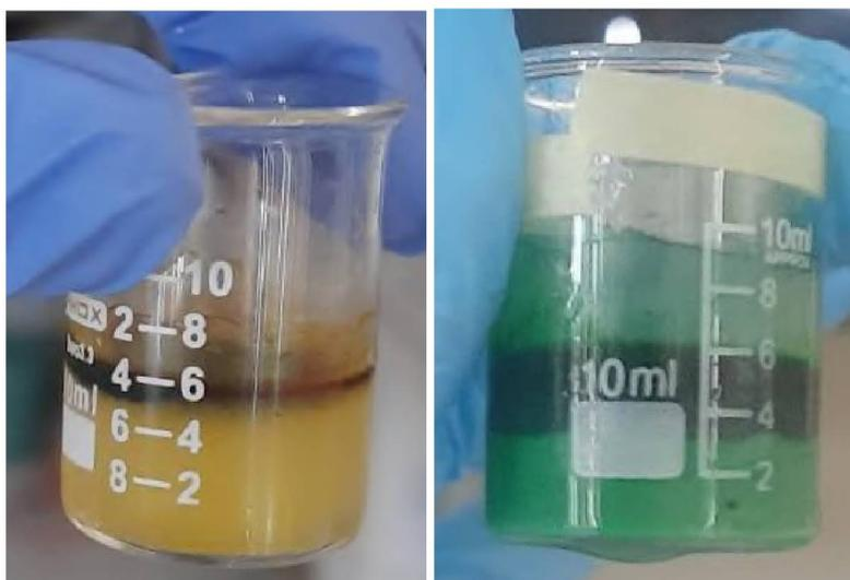
**Figura 107:** Foto das dispersões de nanopartículas a base de água por reprecipitação com 3 mg/ml a base de toluol de F8T2:PCBM e F8T2:ITIC respectivamente.
