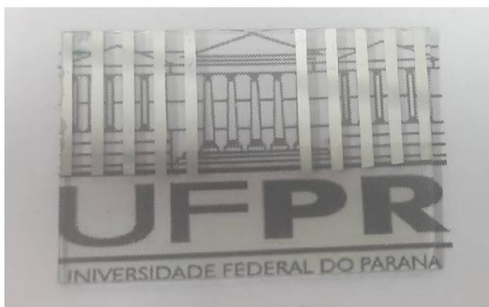
**Figura 93:** Foto do dispositivo produzido por Slot Die Coating mostrando sua alta transparência.
