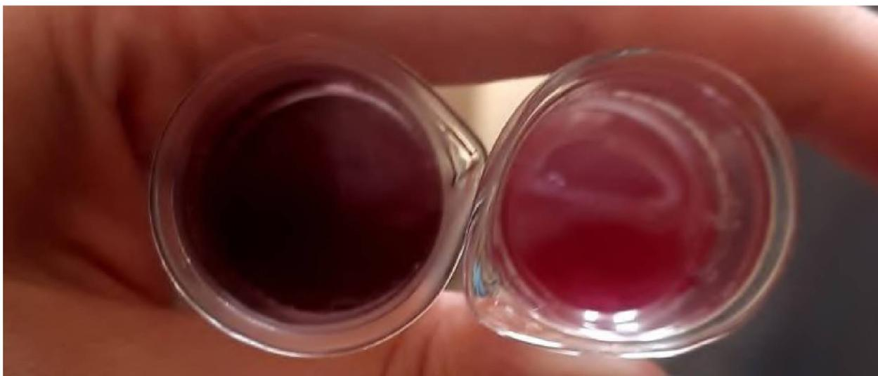
**Figura 73:** Foto das soluções obtidas de P3HT:GO a partir das concentrações iniciais de 3 mg/ml e 0,5 mg/ml respectivamente de P3HT em THF.
