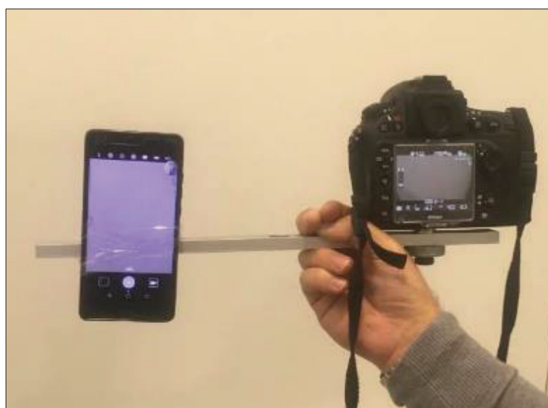
FIGURA 49 - O SISTEMA FOTOGRAMÉTRICO ARTESANAL UTILIZADO NO LEVANTAMENTO.
