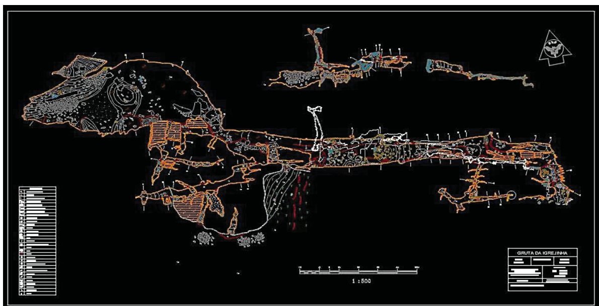
FIGURA 6 - GRUTA DA IGREJINHA, OURO PRETO, MINAS GERAIS. MAPA FEITO PELA SEE EM 1985 COM NÍVEL DE PRECISÃO E DETALHAMENTO 6D (BCRA), RASTERIZADO E VETORIZADO EM AUTOCAD EM 2001.
