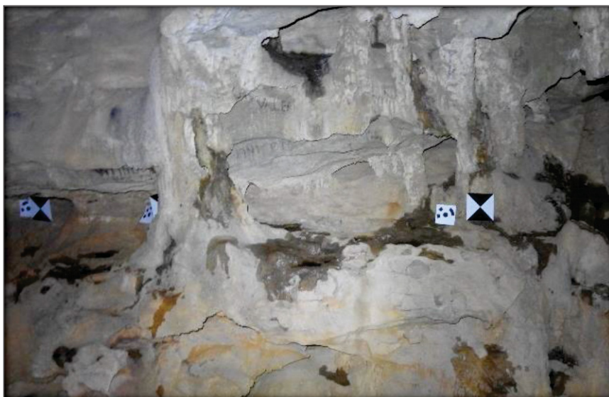
FIGURA 116 – EXEMPLOS DE ALVOS CODIFICADOS PARA REFERENCIA ESPACIAL AOS LEVANTAMENTOS FOTOGRAFÉTRICO E POR VARREDURA A LASER.
