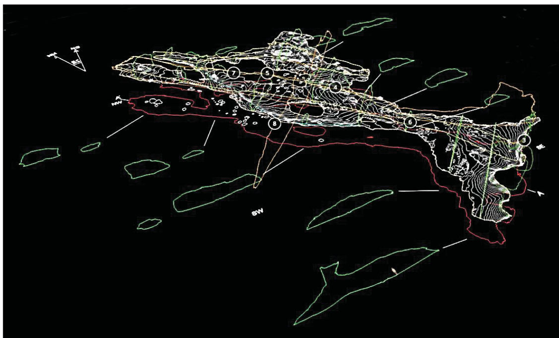
FIGURA 20 - EXTRAÇÃO VETORIAL DOS CONTORNOS DA CAVIDADE EM PLANTA BAIXA (VERMELHO), PERFIL LONGITUDINAL (LARANJA), PROJEÇÃO VERTICAL LONGITUDINAL NW-SE (EM MARROM), PROJEÇÃO VERTICAL TRANSVERSAL NE-SW (LARANJA), CORTES TRANSVERSAIS (VERDE), CORTES TRANSVERSAIS ROTACIONADOS E TRANSLADADOS (VERDE E EM PLANTA) E CURVAS DE NÍVEL COM EQUIDISTÂNCIA DE 10 CM (CINZA).
