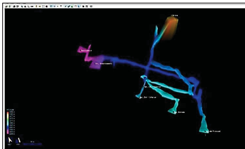
FIGURA 89 - MODELO TOPOGRÁFICO 3D DA GRUTA DO BOCÃO, P.E. DO IBITIPOCA - MG PRODUZIDO PELO SOFTWARE THERION E VISUALIZADO NO SOFTWARE LOCH.
