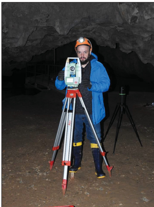
FIGURA 117 - LEVANTAMENTO TOPOGRÁFICO COM ESTAÇÃO TOTAL LEICA TCRA 1200, COM O SCANNER LEICA BLK 360 AO FUNDO.
