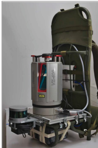
FIGURA 34 - A MOCHILA COM OS LASER SCANNERS RIEGL VZ-400 E VELODYNE VLP16 LITE.
