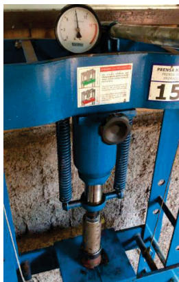
FIGURA 2- Prensa hidráulica utilizada no processo de briquetagem.
