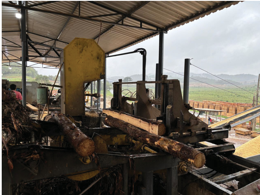
FIGURA 6 - SERRA FITA DE UMA SERRARIA DE PINUS NO MUNICÍPIO DE ITAPERUÇU.
