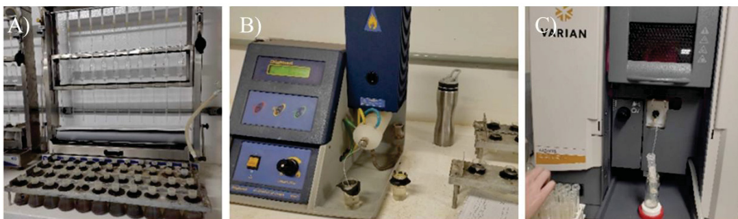
Figura 35 - Extração e leitura de macronutrientes no solo: A) pipetador automático para extração em Mehlich I; B) fotômetro de chama na determinação de K e Na; C) espectrofotômetro de absorção atômica para determinação de Ca e Mg.
