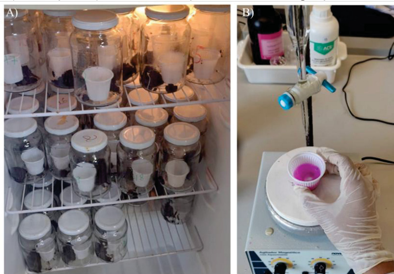
Figura 17 - A) Incubação e B) leitura via titulação da análise da Respiração Basal do Solo (RBS).
