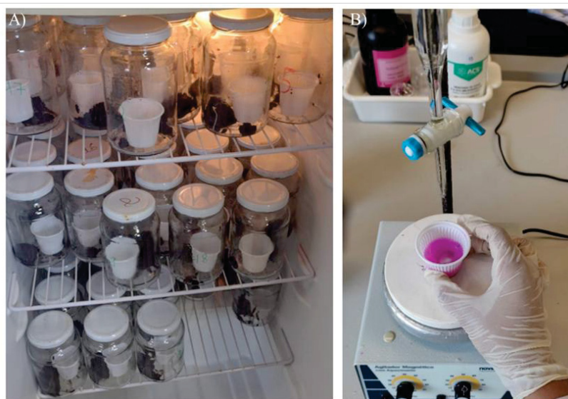
Figura 38 - A) Incubação e B) leitura via titulação da análise da Respiração Basal do Solo (RBS).
