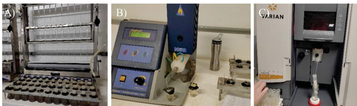
Figura 16 - Extração e leitura de macronutrientes no solo: A) pipetador automático para extração em Mehlich I; B) fotômetro de chama na determinação de K e Na; C) espectrofotômetro de absorção atômica para
