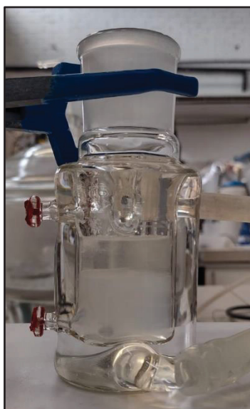
FIGURA 8 – CÉLULA UTILIZADA NO PROCESSO DE SALTING OUT
