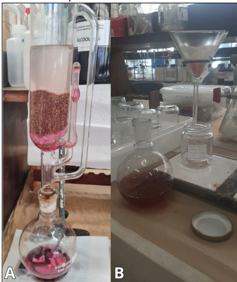
Figura 6 - Processo de obtenção do extrato das cascas da batata-doce roxa por Soxhlet
