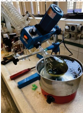
FIGURA 10 – ROTA EVAPORADOR, EQUIPAMENTO UTILIZADO PARA CONCENTRAR OS EXTRATOS BRUTOS E FRAÇÕES.
