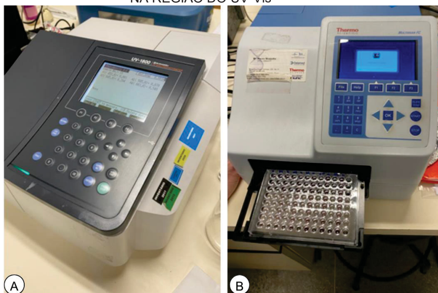
FIGURA 14 – ESPECTROFOTÔMETROS UTILIZADOS NOS EXPERIMENTOS DE ABSORÇÃO NA REGIÃO DO UV-Vis
