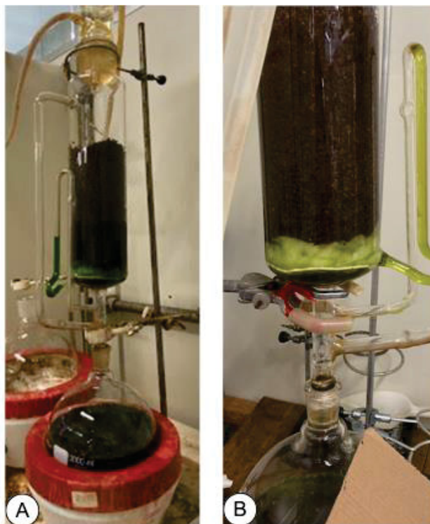
FIGURA 9 - EXTRAÇÃO HIDROALCÓOLICA DAS FOLHAS E CAULE UTILIZANDO APARATO SOXHLET
