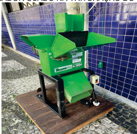
FIGURA 7 - TRITURADOR USADO NA TRITURAÇÃO DO MATERIAL VEGETAL
