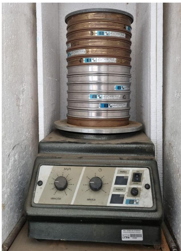
Figura 6: Jogo de peneiras de mesh diferentes no equipamento de rotação para granulometria (Autor, 2024)
