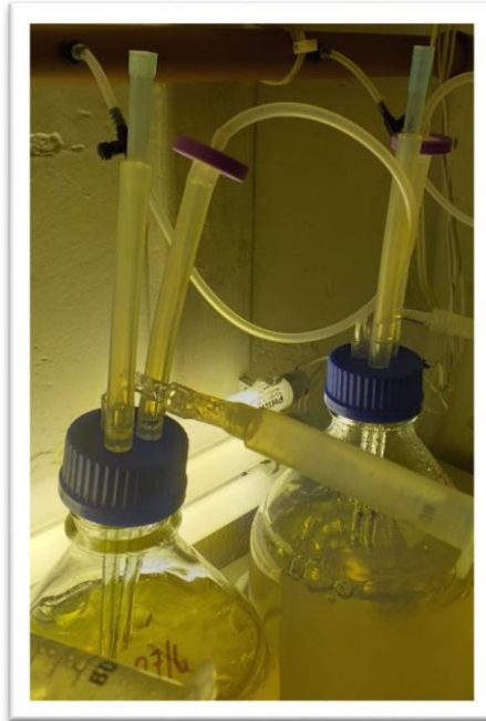
FIGURA 7 – Cultura mantida em constante movimentação, através de suprimento de ar
