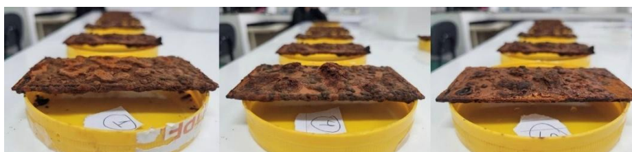
Figura 26 - Espessura do biofouling nas placas dos Biobox 1, 4 e 9 após 12 meses de experimento.
