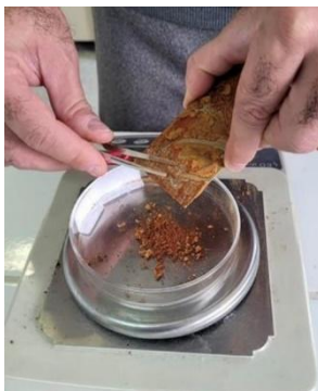
Figura 11 - Raspagem e pesagem do material incrustado nas placas amostrais
