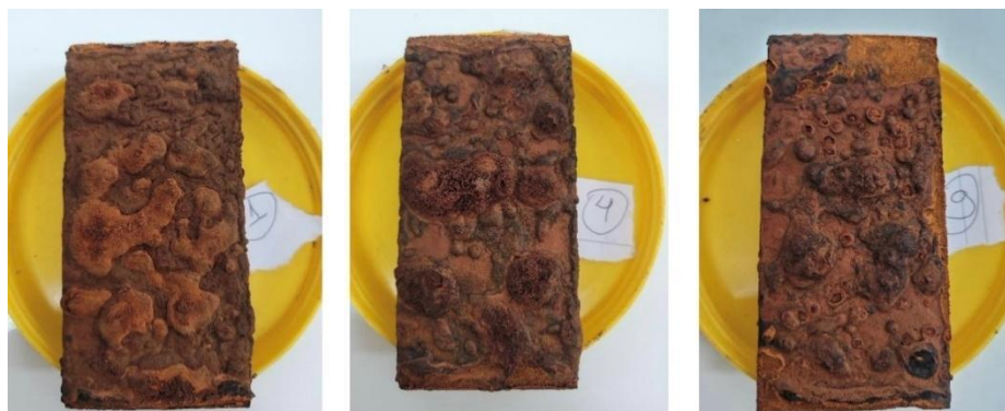
Figura 25 - Quantidade de biofouling das placas dos Biobox 1, 4 e 9 após 12 meses de experimento.
