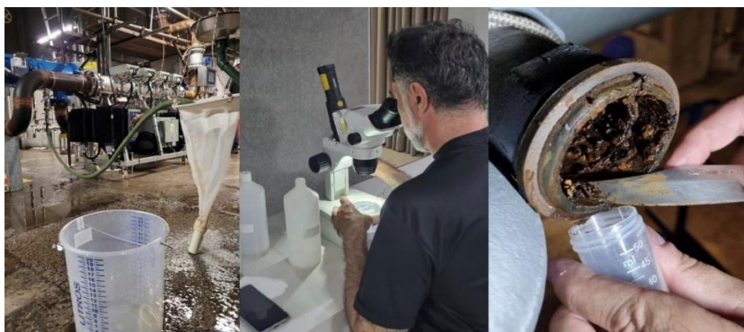
Figura 12 - Rede de Plâncton filtrando água da saída do filtro do Sistema UV HOD; Análise de amostras de água em microscópio estereoscópio; Raspagem interna de tubulação para contagem de organismos incrustantes.
