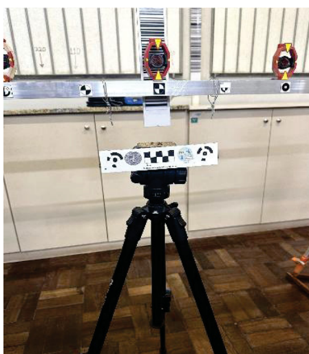
Figura 3.2.3 – Distribuição dos alvos fotogramétricos
