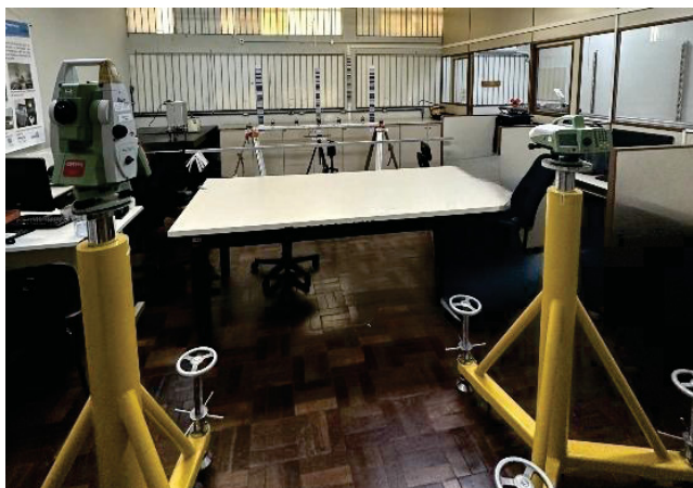
Figura 3.2.2 – ETR TS15 e Nível DNA03 instalados sobre tripés industriais.
