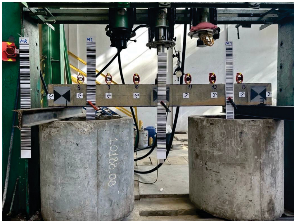
Figura 4.2.7 – Posicionamento das miras de leitura de código de barras
