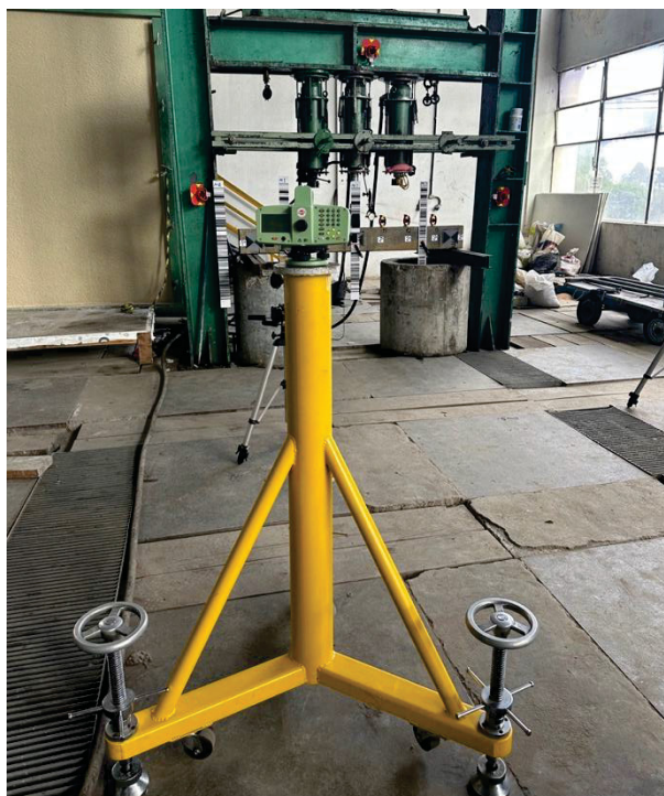
Figura 4.2.8 – Nível geodésico DNA03 sobre tripé industrial em local estável.
