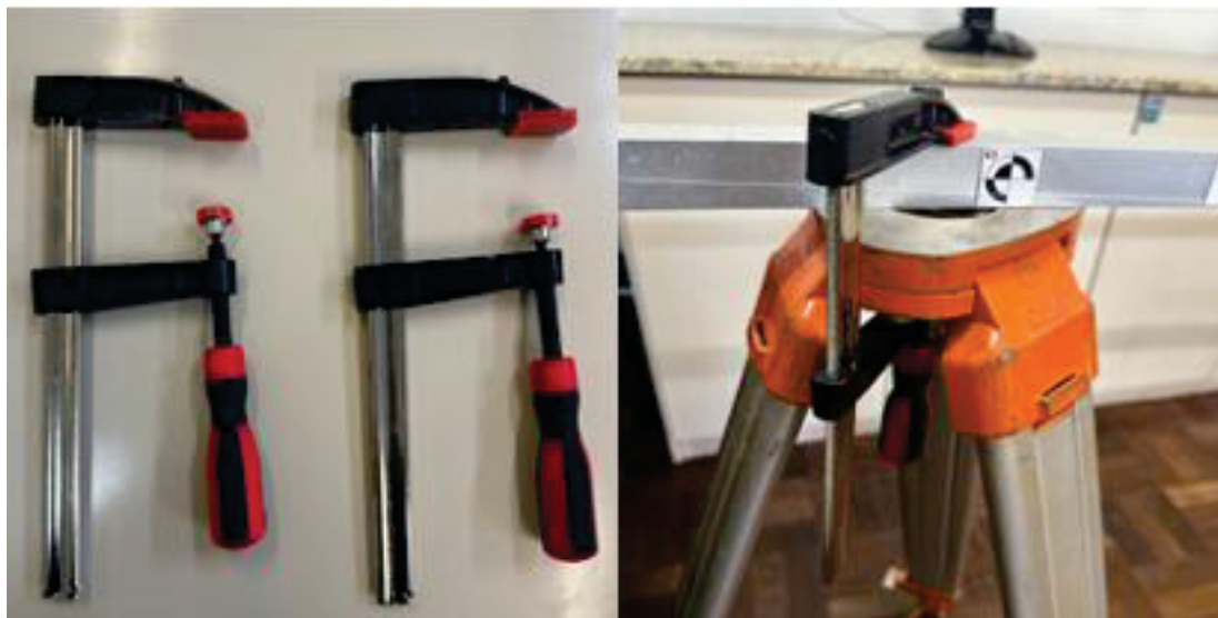
Figura 2.2.2 – Grampos utilizados para fixar a barra aos tripés.
