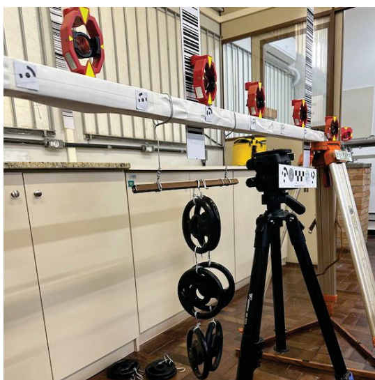
Figura 2.2.3 – Barra exposta a carga de 6 kg
