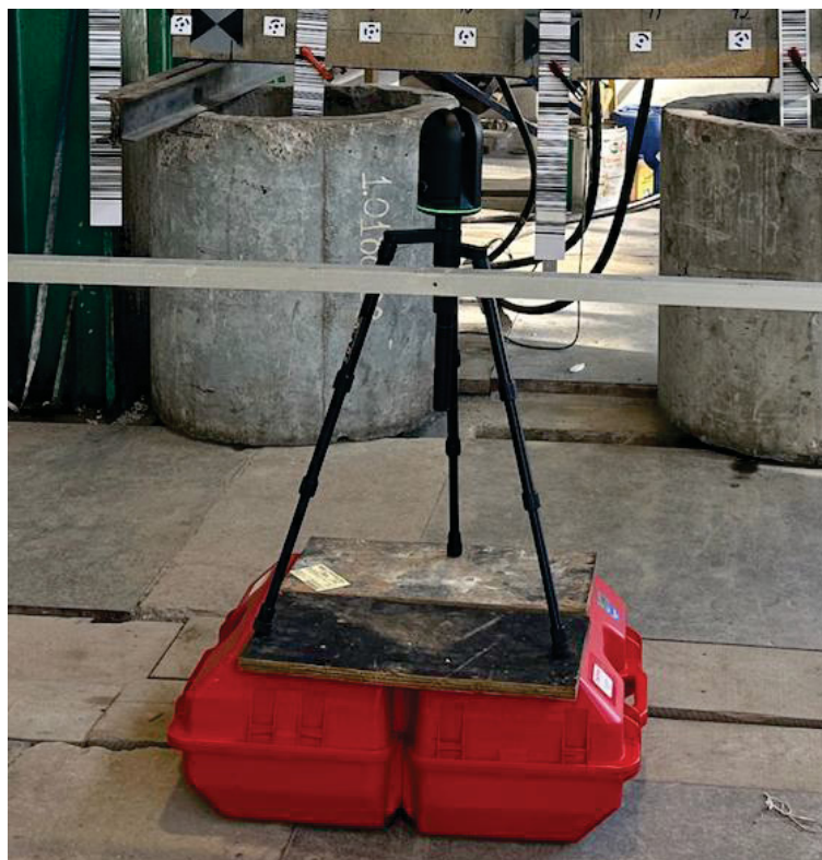
Figura 4.2.12 – Laser scanner BLK360 utilizado
