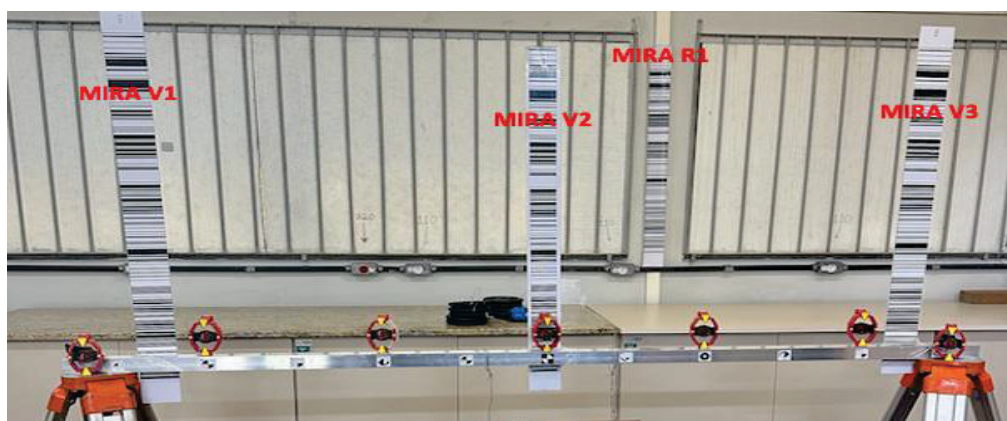
Figura 2.2.4 – Disposição das miras utilizadas
