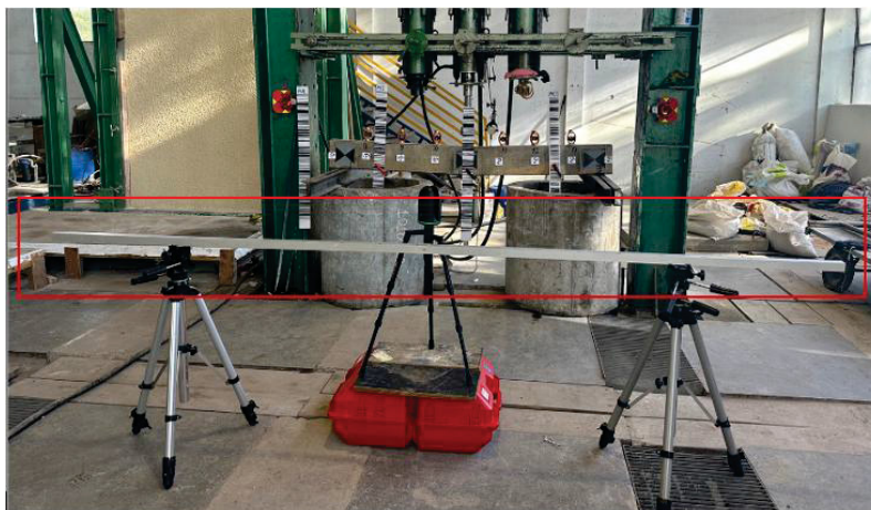
Figura 4.2.10 – Barra graduada para tomada de imagens fotogramétricas
