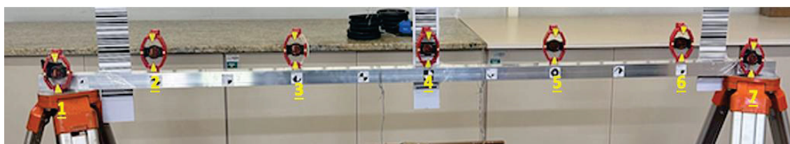
Figura 3.3.2 – Nomenclatura aplicada aos miniprismas
