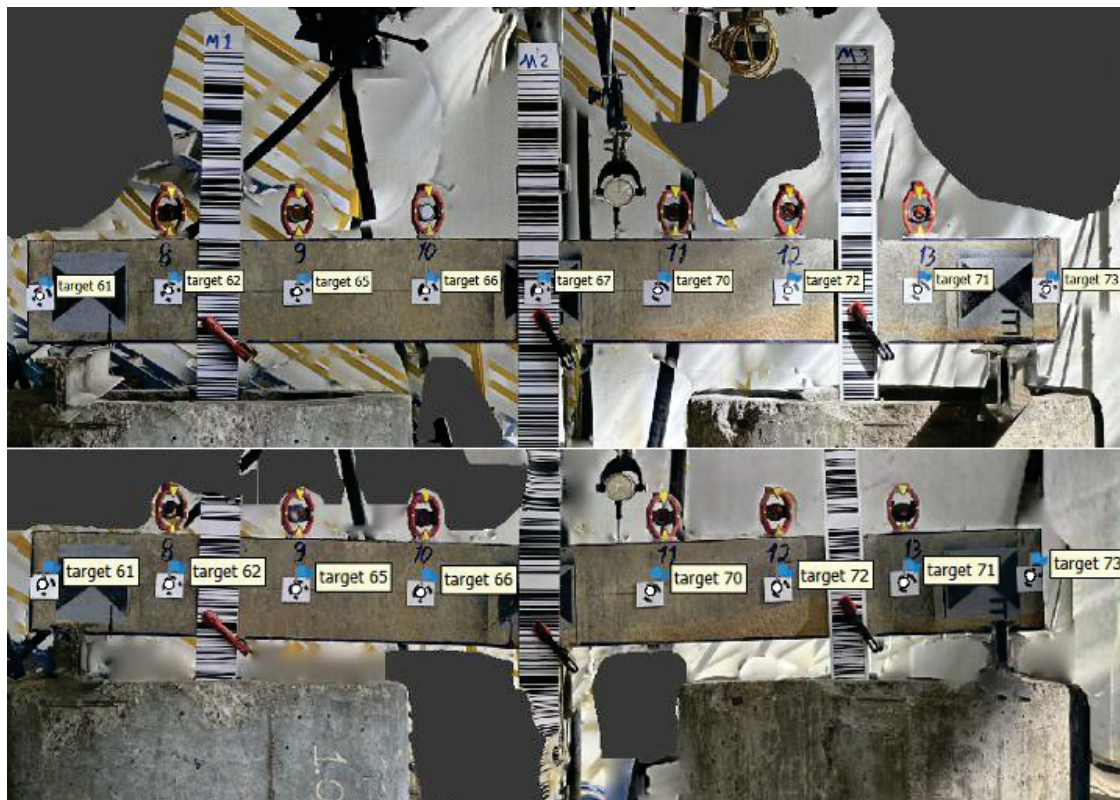
Figura 4.2.11 – Alvos detectados automaticamente pós-processamento
