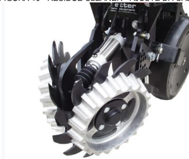
FIGURA 10 - RESIDUE CLEANER - AJUSTE DA CABINE
