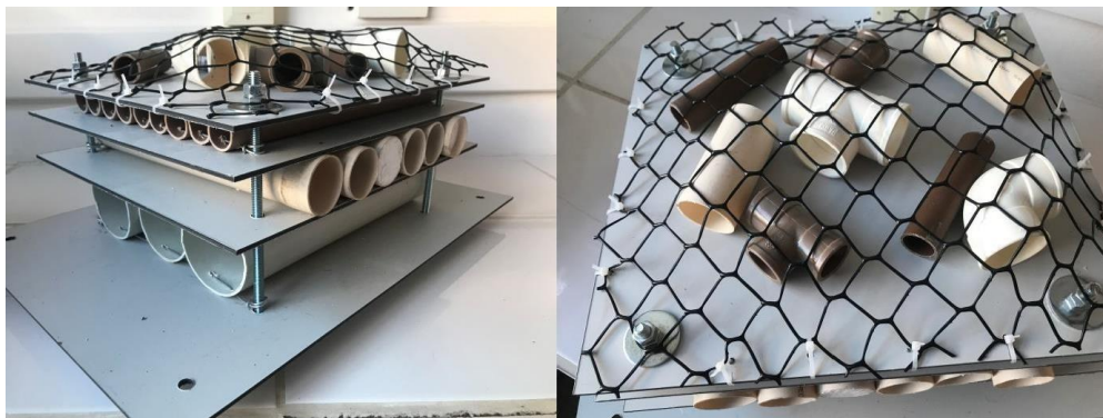
FIGURA 2 – Estruturas utilizada para a captura do peixes no Complexo Estuarino de Paranaguá ( Fish-specific autonomous reef monitoring structures FARMS).
