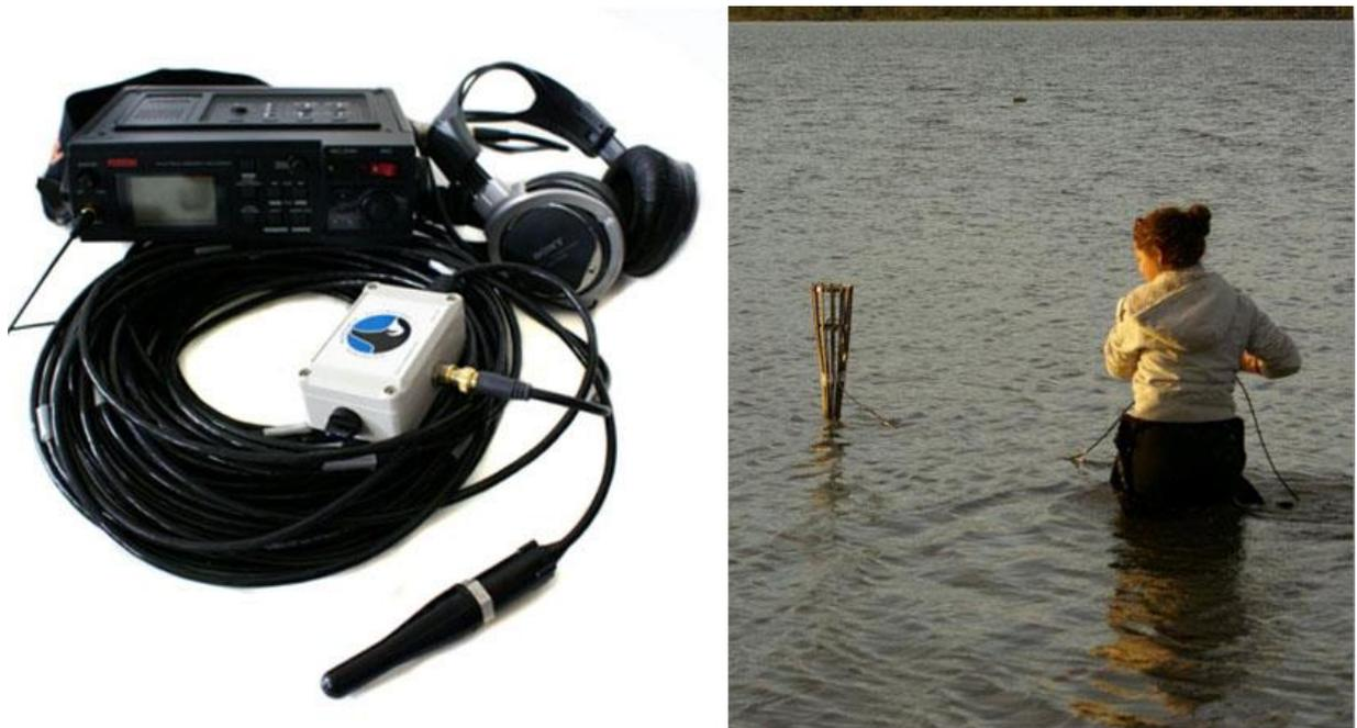
Figura 2. Hidrofone modelo C55 e amplificador da *Cetacean Research Technology* e gravador digital Fostex FR2 utilizado e gravação de *S. guianensis* na Ilha das Peças.
