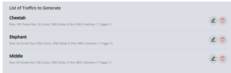
Figura 5.15: Leaky Bucket : parametrização dos tráfegos.
