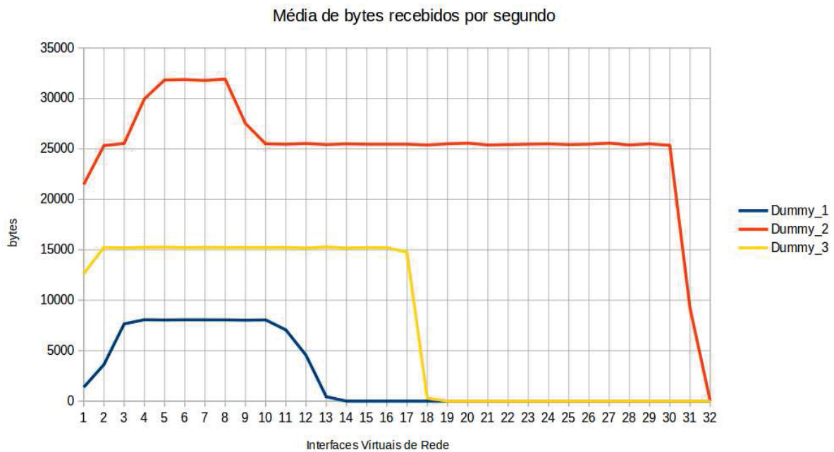
Figura 5.8: Stateful Load Balancer : gráfico da média de bytes recebidos por segundo pelas interfaces.
