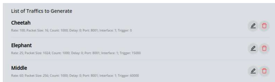
Figura 5.14: Leaky Bucket : parametrização dos tráfegos.
