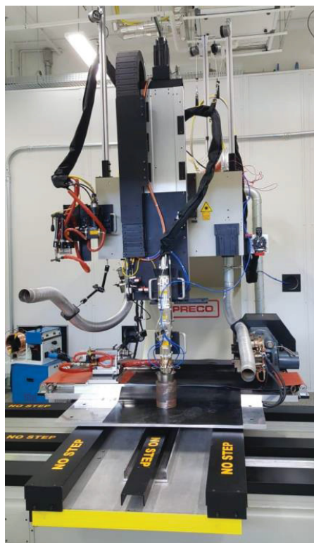
FIGURA 9 – INSTALAÇÕES GERAIS DO EQUIPAMENTO LASER CLADDING FABRICANTE PRECO
