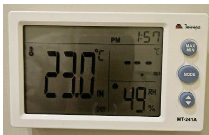
FIGURA 9 – TERMÔMETRO DIGITAL INDICANDO A TEMPERATURA DA SALA NO MOMENTO DAS COLETAS DE IMAGENS TERMOGRÁFICAS.
