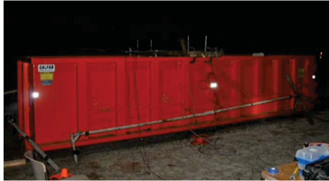
FIGURA 2.26 - PROTÓTIPO EM ESCALA PARA TESTES DE LABORATÓRIO DE DETONAÇÕES COM INSTRUMENTAÇÃO.,
