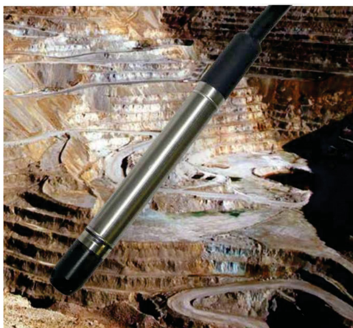
FIGURA 3.14 – PIEZÔMETRO ELÉTRICO UTILIZADO NOS TESTES DE CAMPO;
