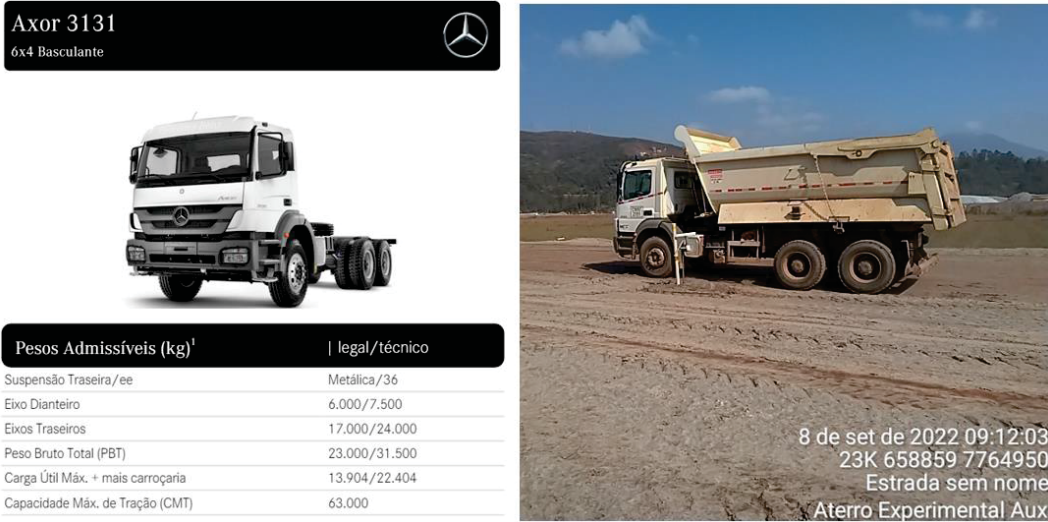
FIGURA 3.16 – CAMINHÃO BASCULANTE – CATÁLOGO E FOTO DO EQUIPAMENTO DURANTE OS TESTES.
