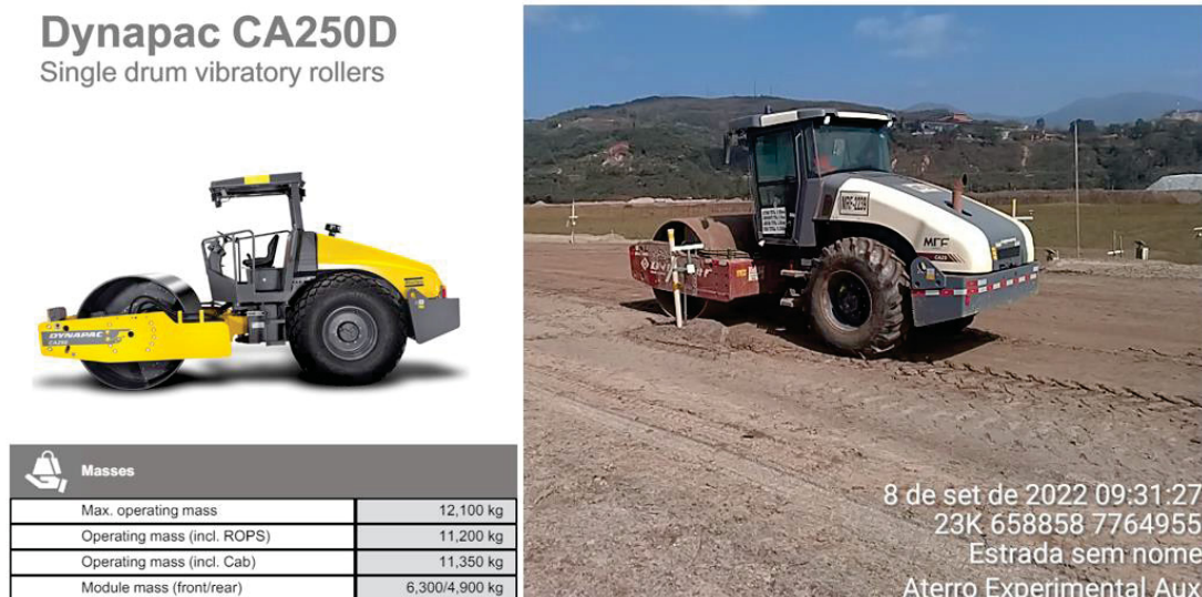
FIGURA 3.20 – ROLO LISO – CATÁLOGO E FOTO DO EQUIPAMENTO DURANTE OS TESTES.
