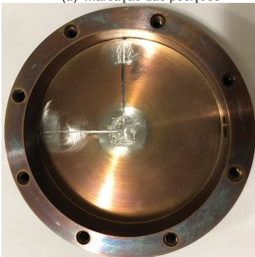
(c) Lixamento da superfície
