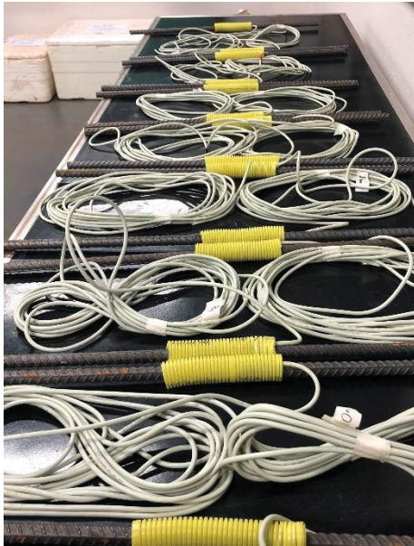
(a) Extensômetros de imersão montados
