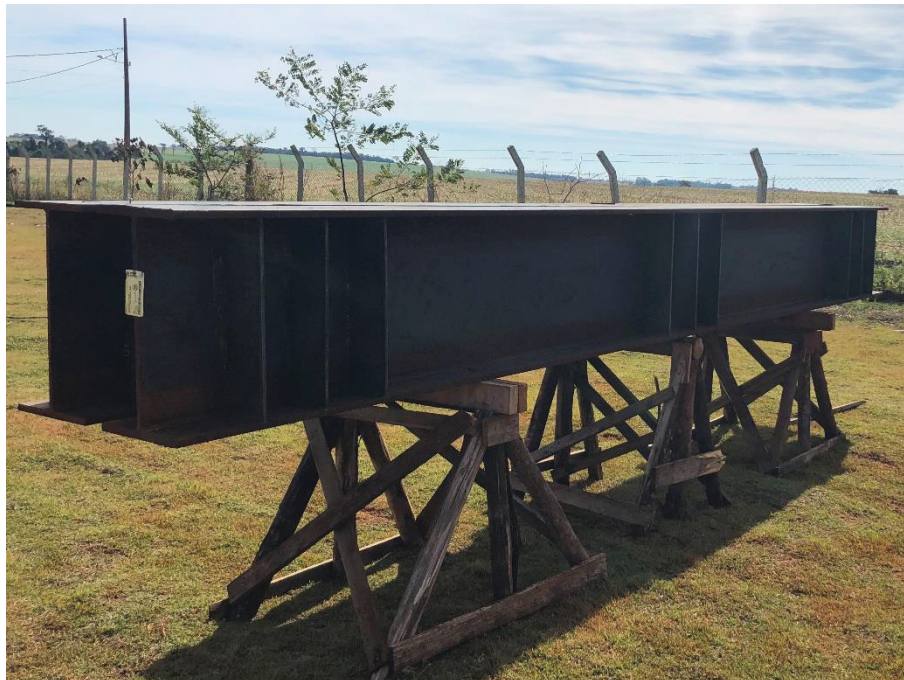
FIGURA 64 – DETALHE DO POSICIONAMENTO ENRIJECEDORES NA VIGA
