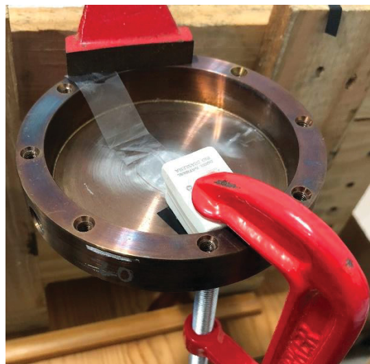
(d) Colagem com compressão
