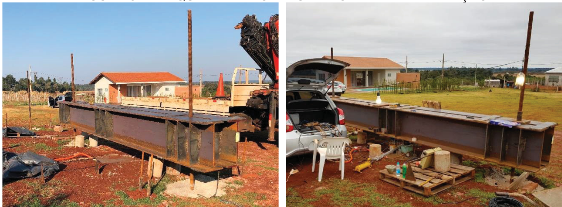
FIGURA 57 – ESQUEMA DE MONTAGEM DO SISTEMA DE REAÇÃO
