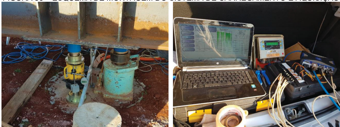
FIGURA 56 – ESQUEMA DE MONTAGEM DO SISTEMA DE CARREGAMENTO E AQUISIÇÃO
