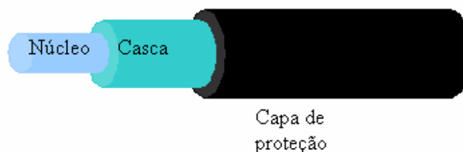
Figura 2-1 Estrutura física de uma fibra óptica plástica.
