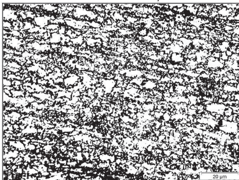
Figura 46 - FASE MARTENSÍTICA DESTACADA PARA A PEÇA N, COM 100X DE AMPLIAÇÃO
