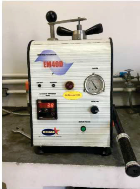
Figura 33 - EMBUTIDORA METALOGRÁFICA UTILIZADA
