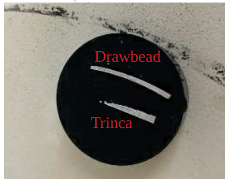
Figura 35 - AMOSTRAS EMBUTIDAS E LIXADAS
