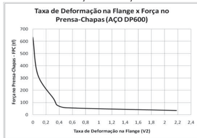
Figura 14 - VARIAÇÃO DA TAXA DE DEFORMAÇÃO NA FLANGE EM FUNÇÃO DA FORÇA DO PRENSA
