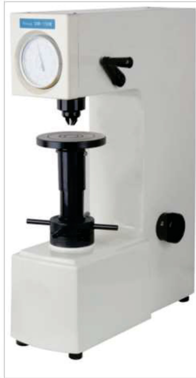
Figura 32 - EXEMPLO DE EQUIPAMENTO UTILIZADO PARA MEDIÇÃO DE DUREZA ROCKWELL
