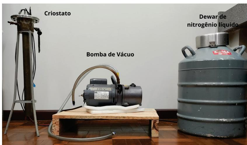
FIGURA 21 – Foto mostra os equipamentos necessários para a medida elétrica em baixa temperatura. Da esquerda para direita: tubo metálico onde foi colocado a amostra, bomba de vácuo, Dewar de nitrogênio.
