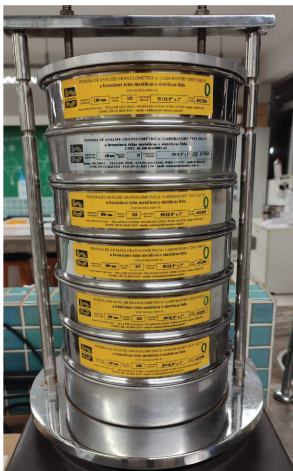
FIGURA 13 - ORGANIZAÇÃO DAS PENEIRAS PARA REALIZAÇÃO DA ANÁLISE DE PERFIL GRANULOMÉTRICO
