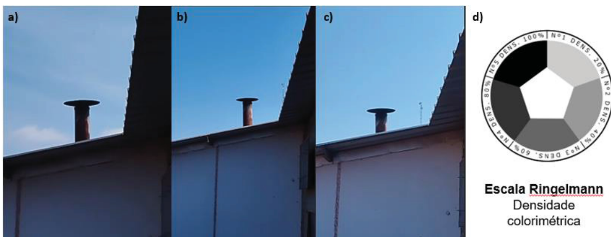
FIGURA 25 - ASPECTO DA FUMAÇA EMITIDA PARA OS TESTES COM A) TL0, B) TL10 E C) TL20 EM COMPARAÇÃO COM A D) ESCALA RINGELMANN
