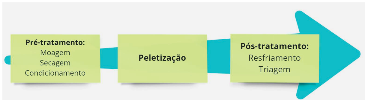
FIGURA 7 - ETAPAS GERAIS DO PROCESSO DE PELETIZAÇÃO
