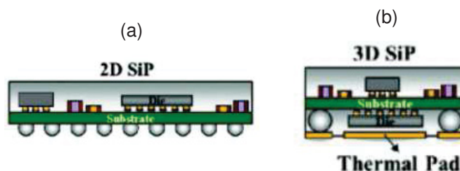
FIGURA 6 – EXEMPLOS DE ESTRUTURAS EM SIPS
