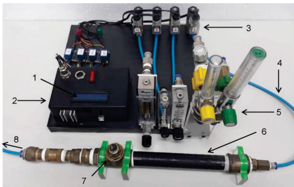
Aparato com display LCD(1), placa arduino®(2), válvulas solenóides(3), mangueiras(4), rotâmetros(5), sonda(6), câmara(7), saída de ar/vapores do sistema(8)
