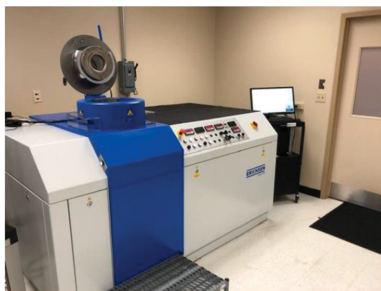
FIGURA 63 – MÁQUINA UNIVERSAL DE ENSAIO DE CHAPAS METÁLICAS – ERICHSEN MODELO 145-60
