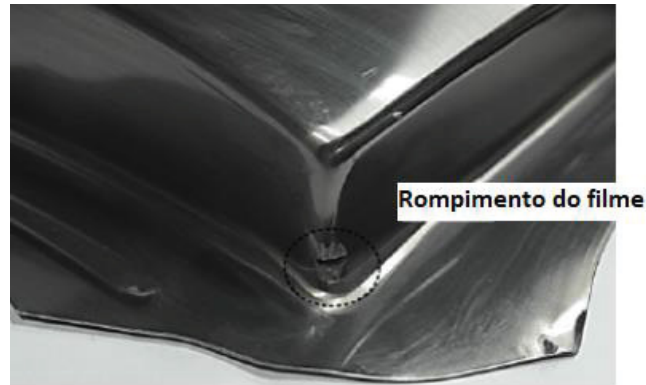
FIGURA 30 – MODO DE FALHA RUPTURA DO FILME PET
