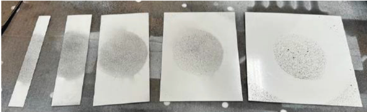
FIGURA 68 – CORPOS DE PROVA COM PADRÃO ESTOCÁSTICO PARA MEDIÇÃO DAS DEFORMAÇÕES POR DIC
