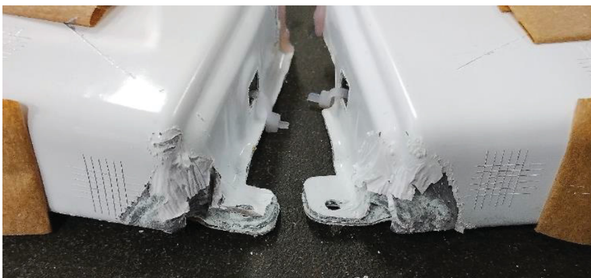
FIGURA 144 – MODOS DE FALHA DO REVESTIMENTO ENCONTRADOS NA ESTAMPAGEM REAL DO PAINEL FRONTAL
