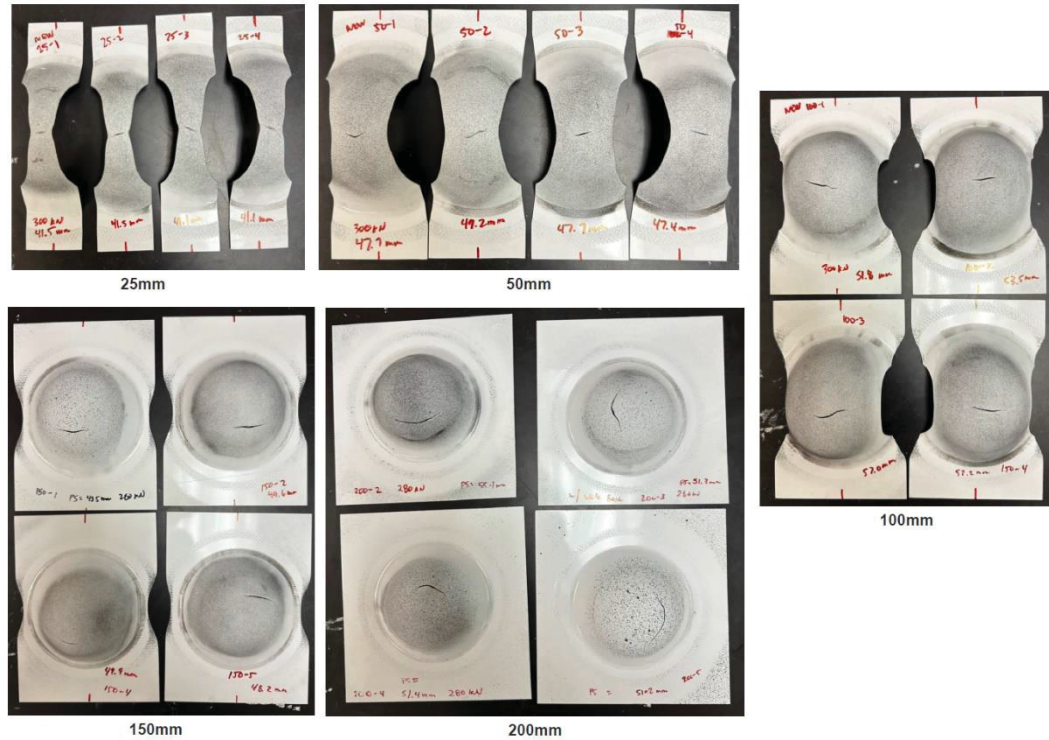
FIGURA 95 – CORPOS DE PROVA ENSAIO NAKAJIMA PARA OBTENÇÃO CLC AÇO
