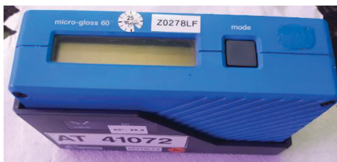
FIGURA 74 – MEDIDOR DE BRILHO BYK-GARDNER MICRO-GLOSS 60 GRAUS, MODELO 4501
