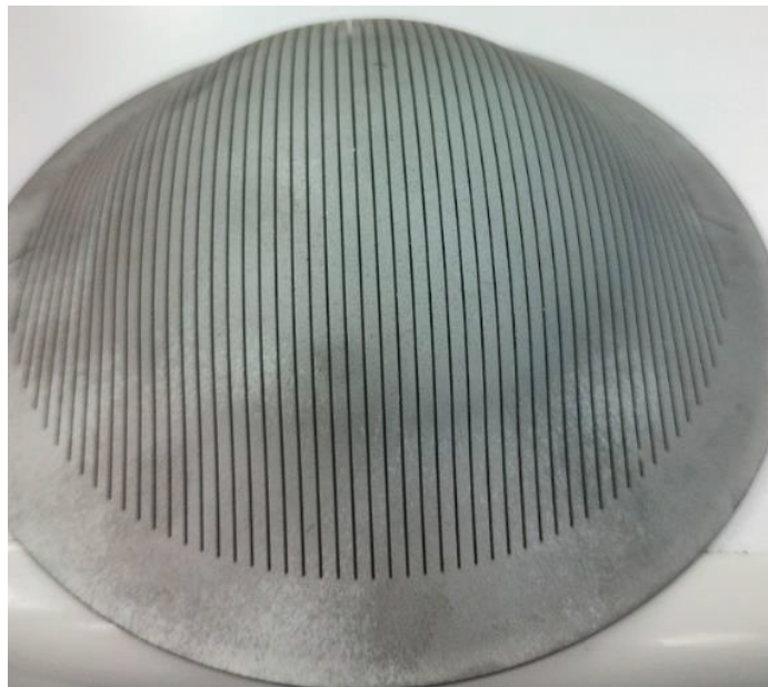
FIGURA 84 – GABARITO CORTE EM GRADE PARA CORPOS DE PROVA NAKAJIMA
