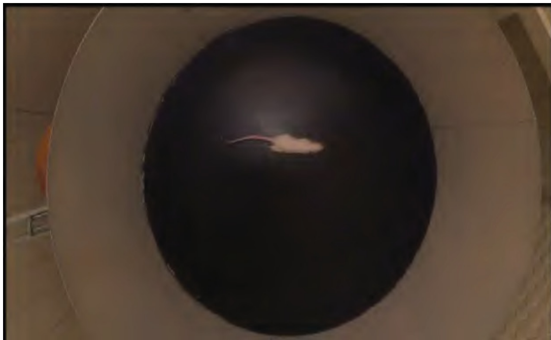
Figura 6: Aparato do Campo Aberto. Arena circular com 1 metro de diâmetro. O animal permanece durante 5 minutos e a filmagem é analisada pelo software.
