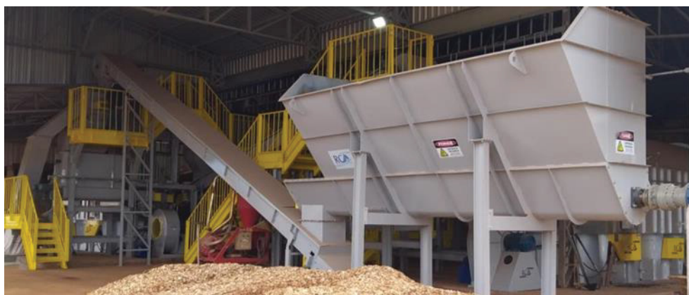
FIGURA 6 - Moega dosadora transportadora dupla
