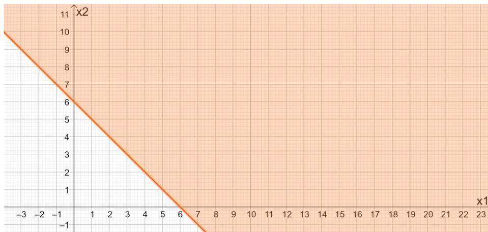
Figura 19: Representação da restrição  $6x_1 + 6x_2 \geq 36$
