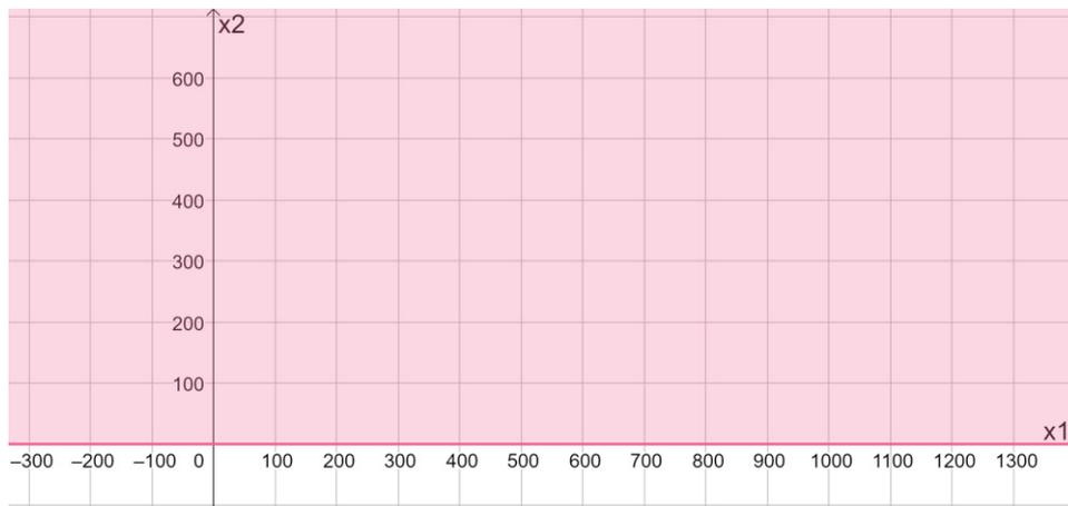
Figura 32: Representação da restrição  $x_2 \geq 0$
