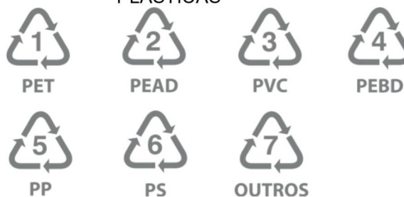
FIGURA 2 - SIMBOLOGIA DE IDENTIFICAÇÃO DE PRODUTOS E MATÉRIAS-PRIMAS PLÁSTICAS
