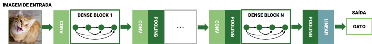
Figura 2.19: Arquitetura da rede DenseNet. Fonte: adaptado de Huang et al. (2017).
