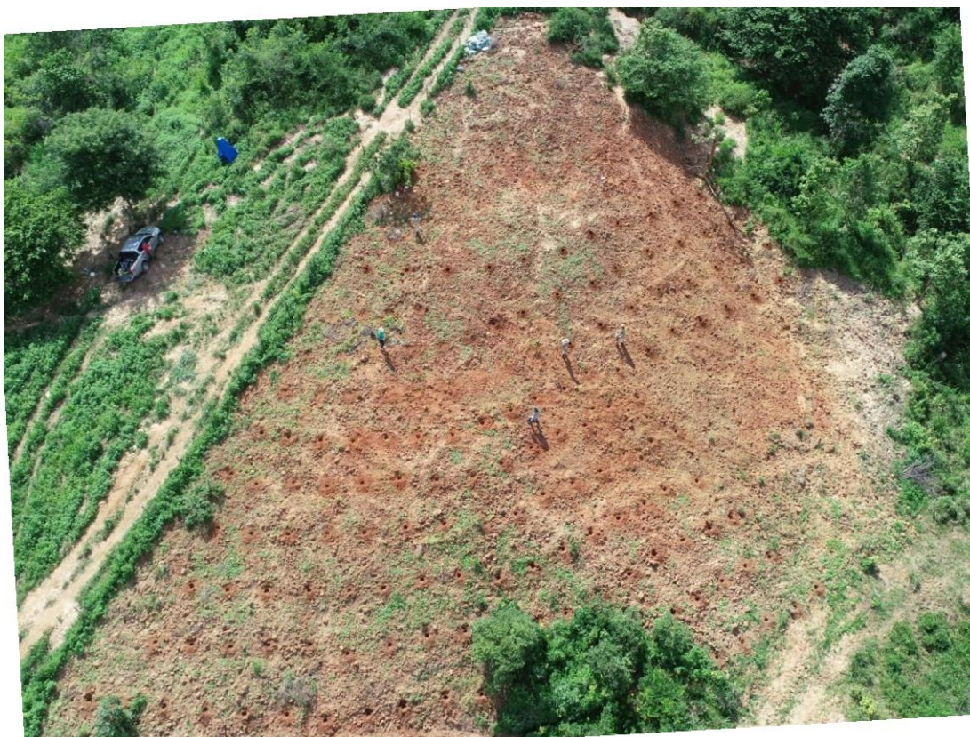
Figura 27: Imagem aérea obtida com RPA Phantom 4 em Galiléia, MG, onde é possível visualizar a contagem dos berços abertos para a restauração florestal. Fonte: Autora (2021)
