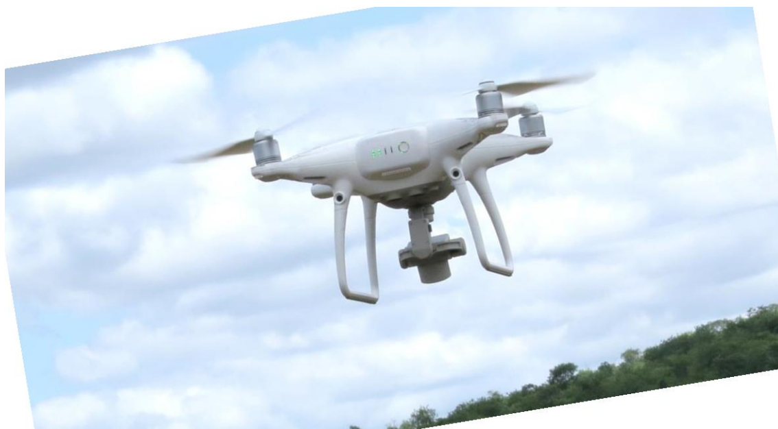
Figura 4: Aeronave Remotamente Pilotada (RPA) DJI Phantom 4, com uma câmera digital RGB embarcada.
