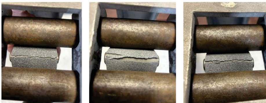
FIGURA 55 AMOSTRA SENDO SUBMETIDA AO ENSAIO DE ADERENCIA POR DOBRAMENTO – COMPOSIÇÃO Nb 2 O 5 50%wtAl
