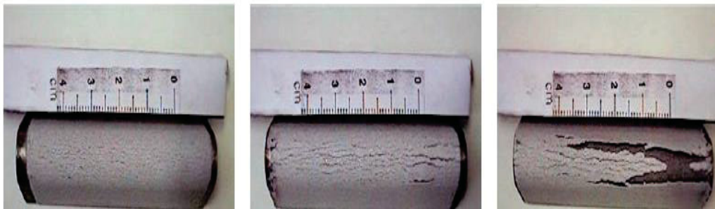
FIGURA 45 PADRÕES PARA AVALIAÇÃO DAS TRINCAS E DESCONTINUIDADES EM CORPOS-DE-PROVA REVESTIDOS E ENSAIADOS POR DOBRAMENTO
