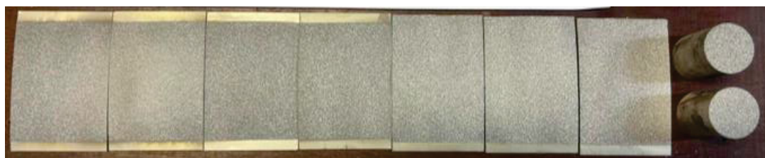
FIGURA 28 CORPOS DE PROVA APÓS DEPOSIÇÃO DO REVESTIMENTO
