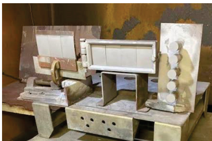
FIGURA 26 DISPOSIÇÃO DOS CORPOS DE PROVA PARA DEPOSIÇÃO
