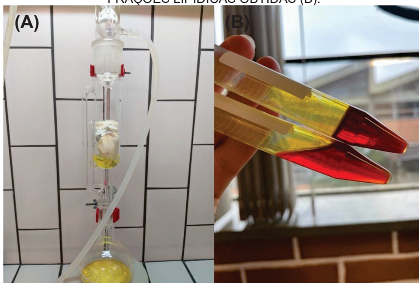
FIGURA 7 – PROCEDIMENTO DE EXTRAÇÃO DO RESÍDUO DA GABIROBA POR SOXHLET (A) E FRAÇÕES LIPÍDICAS OBTIDAS (B).
