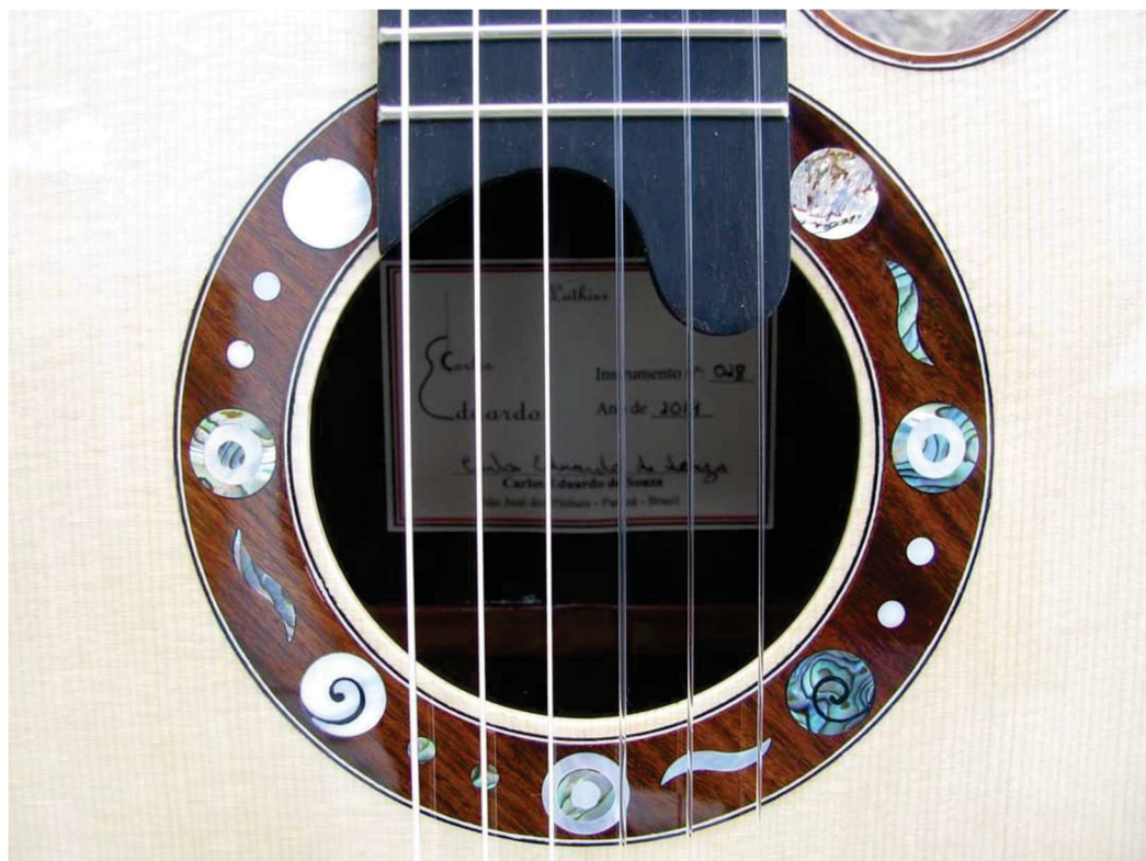
FOTOGRAFIA 27 - DETALHE DA ROSETA FABRICADA COM MADEIRA E CONCHAS E DA BOCA DE UM VIOLÃO
